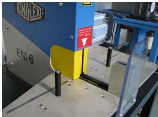
Рис. 3-2 Гибочный стержень установлен для диаметра шланга DN20 3/4"
