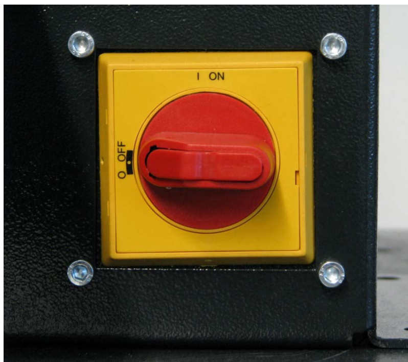
Рис. 2-2 Главный выключатель: ВЫКЛ.
