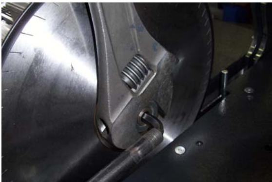
Рисунок 3-10 Гайка 46 мм с левосторонней резьбой
