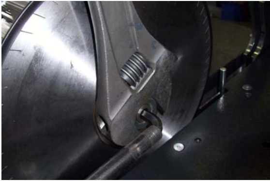
Рисунок 3-7 Гайка 46 мм с левосторонней резьбой
