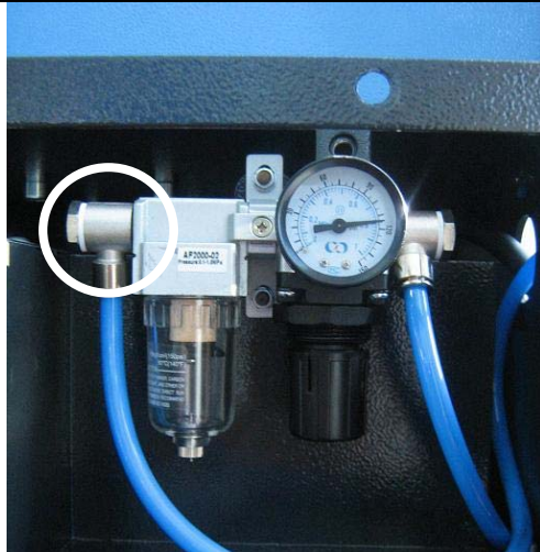
Разъем сжатого воздуха 1/4" и клапан контроля давления
