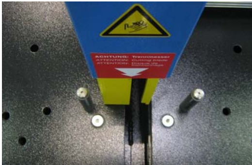
Рисунок 3-3 Сгибающиеся штыри размещены для малых диаметров шланговых трубопроводов
