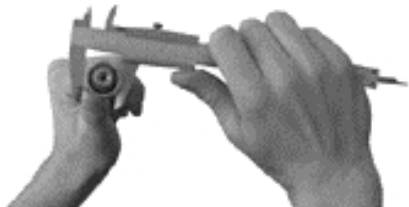
Рис. 4, проверка диаметра прессования
